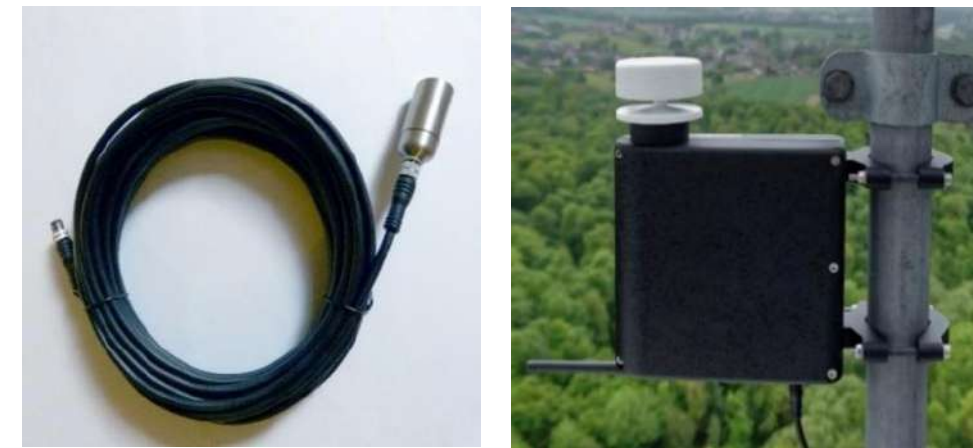
Figure 27 : Microphone mobilisé pour les études en altitude (à gauche) et boîtier TrackBat avec microphones intégrés, installé sur la nacelle d'une éolienne (à droite).
